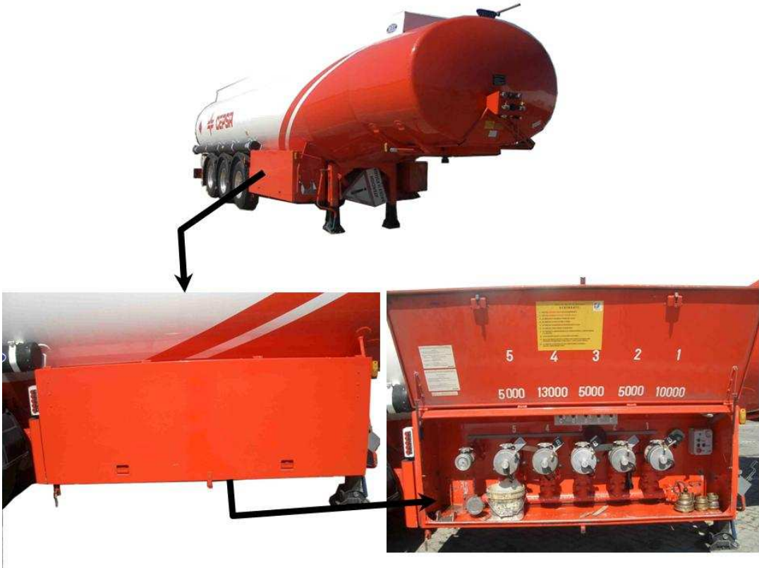
Cajón válvulas conexión rápida
