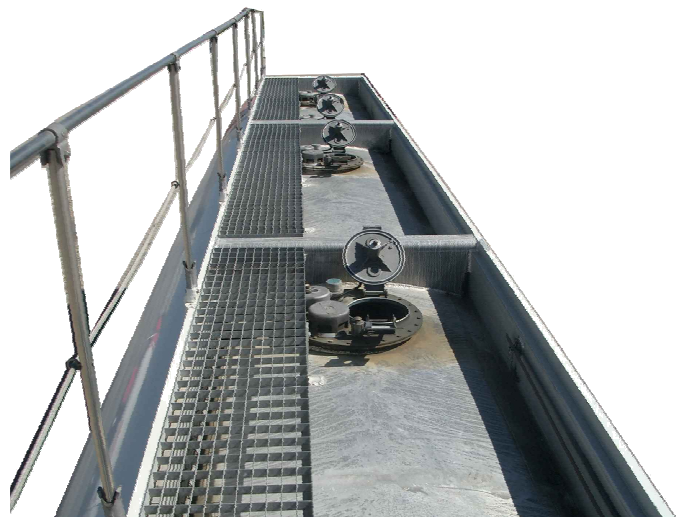
Parte superior donde están situadas las bocas de hombre (tapas) y demás accesorios
