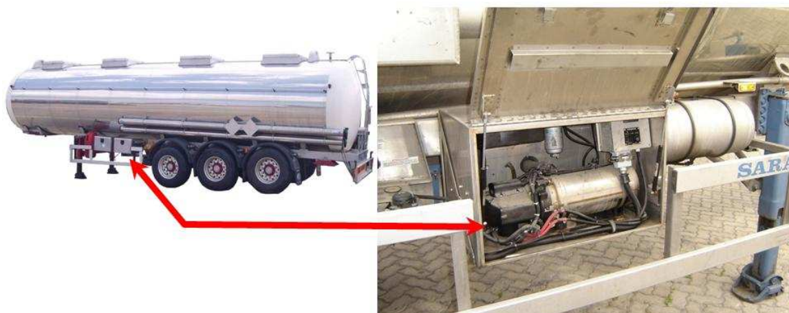
Situación del conjunto autónomo del calentamiento de la cisterna.
