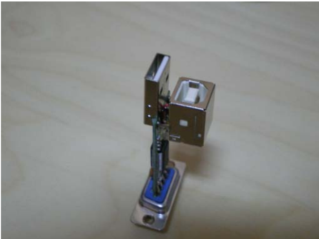
Foto 3 - Aquí con doble conector USB, al final irá solo el type B (el cuadrado de la derecha )
