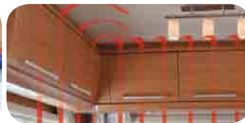
Con los muebles separados de las paredes laterales se obtiene una circulación óptima del aire del interior y se evita la condensación de agua.
